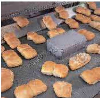
Control de la temperatura del horno en líneas de cocción, con caja de protección contra el calor
